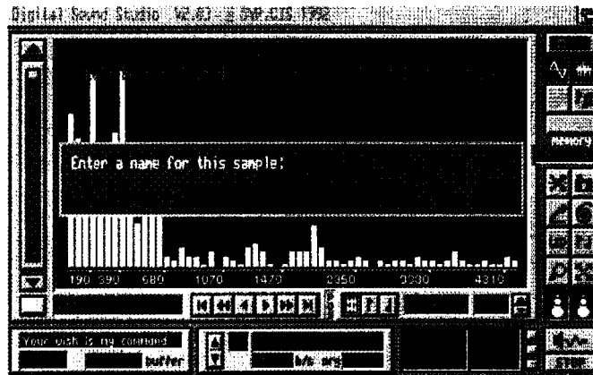
Abbiamo terminato la digitalizzazione: DSS ci chiede un nome per il campione. Sullo sfondo l'analizzatore di spettro.
