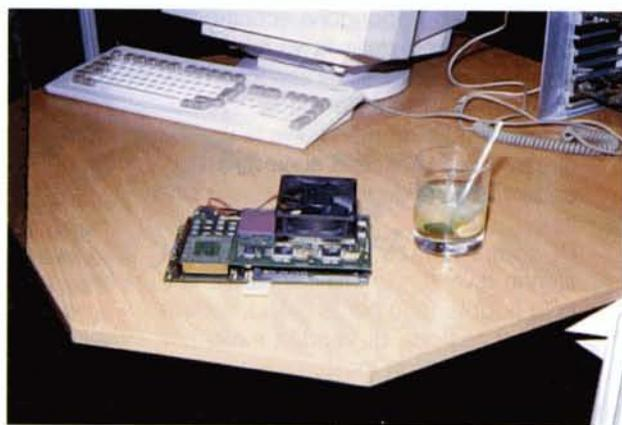
**La Power Up PPC 603e 240 MHz montata su CyberStorm MK II e separate. Sulla destra il Caipirinha (la bevanda)!**
