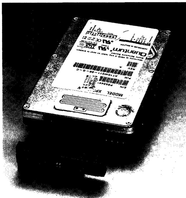
**L'hard disk Quantum XPR Wide da 1 Gb ha un adattatore di serie per connettori Centronics.**
