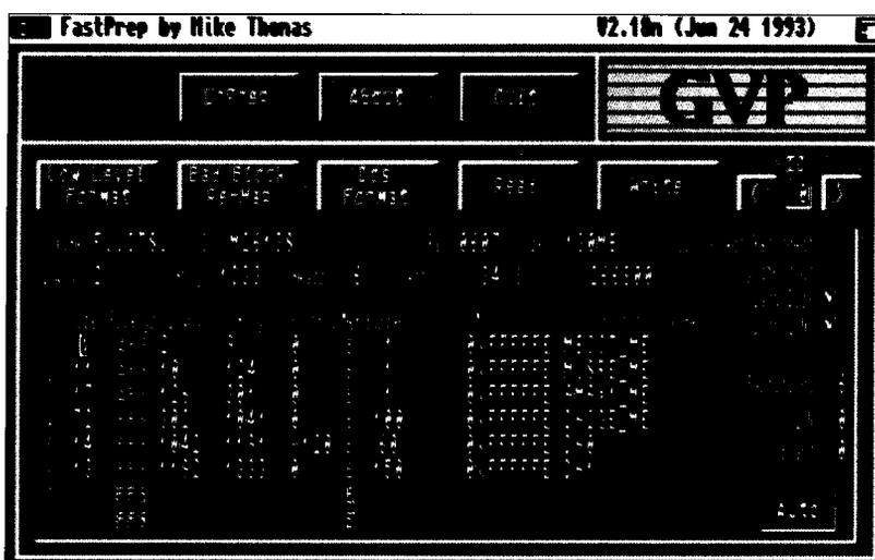
*Lo stesso hard disk di figura 2 visto da Faaastprep. Poiché l'RDB è standard, non ci sono incompatibilità. Tutto è concentrato in un'unica schermata; la voce "Disconnect/Reconnect" equivale a "Supports reselektion" su HDtoolbox. Le voci "last Disk" e "last Lun" saranno spiegate sui prossimi numeri di Amiga Magazine.*
