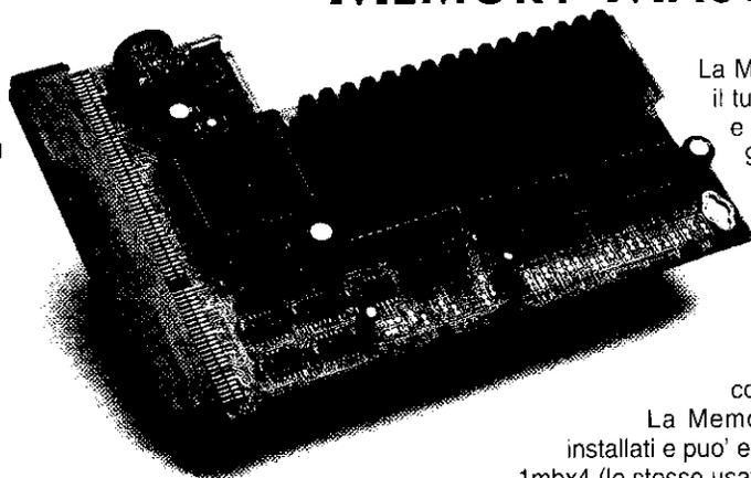
La MemoryMaster 1200 e' l'espansione ideale per il tuo Amiga 1200. Si inserisce nello slot inferiore e ti permette di espandere la memoria fino a 9mb di FAST RAM, aggiunge la batteria tampone per l'orologio ed un coprocessore matematico opzionale 68881/2 fino a 50mhz. Grazie alla FAST RAM a 32bit, il 1200 viene accelerato di circa il doppio (indice AIBB: 1.93, SysInfo: 2.23 volte un Amiga 1200 normale), e fino al 1800% nei calcoli in virgola mobile col coprocessore inserito.
